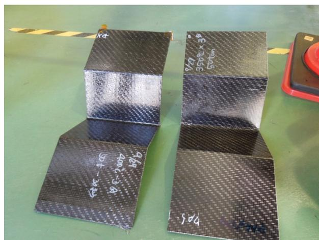
見学会風景4 デモ加工した CFRP 成形品
